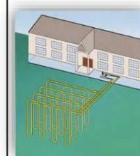
Champ de sondes géothermiques (BRGM)
